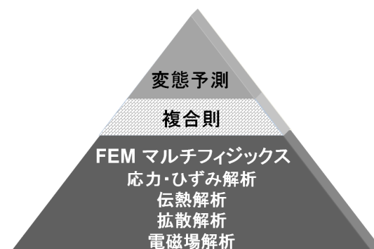
図 2 熱処理シミュレーションソフトの構成
